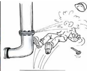
Figure 7 : Exemple de bonne pratique lors de l'ouverture d'un circuit
